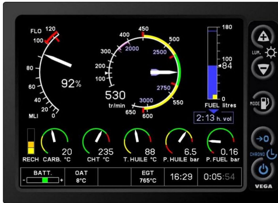
Abbildung 3: Darstellung des EPM. Quelle: Hélicoptères Guimbal
