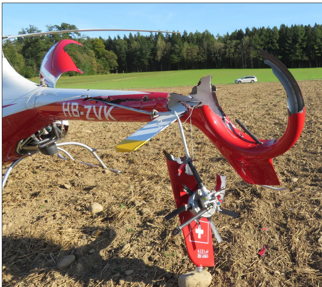
Abbildung 5: Zerstörter Heckausleger der HB-ZVK mit herausgerissenem Heckrotor
