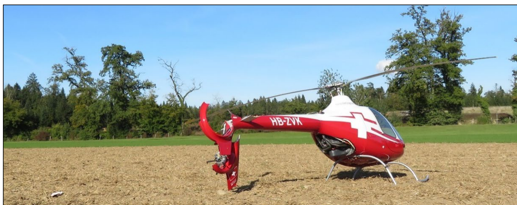
Abbildung 2: Endlage des Helikopter HB-ZVK in Blickrichtung Nordost mit abgetrenntem, ummanteltem Heckrotor.
